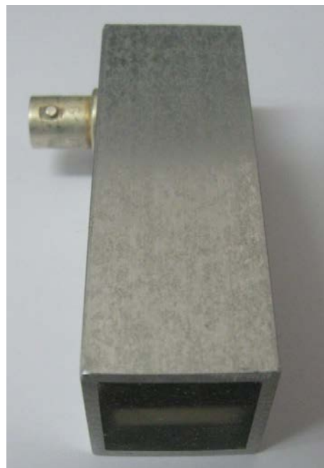
фиг.3 Конструкция на нискочестотен преобразувател
